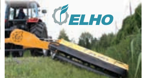
Leikkuupään sivulla sijaitseva kulmavaihte parantaa koneen liikkumavaraa.
