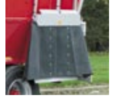
Purkuluukut sivulla kumi/teräsohjureilla
