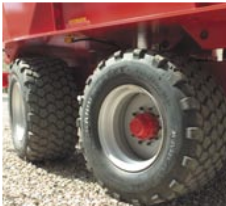
Jousitettu teli, kiinteä tai ohjaava taka-akseli. VM 22-2 B mallissa on vakiona 1 akseli.
