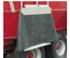
Purkuluukut sivulla kumi/teräsohjureilla
