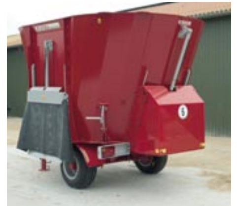
Esimerkki VM 10-1 mallista, johon rakennuksen muutoksen takia on asennettu ylimääräinen takapurkuluukku.
