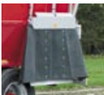
Purkuluukut sivulla kumi/teräsohjureilla
